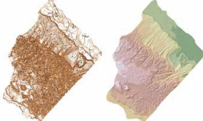
2. Topografia ottenuta mediante fotorestituzione del volo speciale del 2010 e modello digitale del terreno (MDT) di una zona centrale della Bessa (illustrazione EST-AP e LabTel, IH del CSIC)
