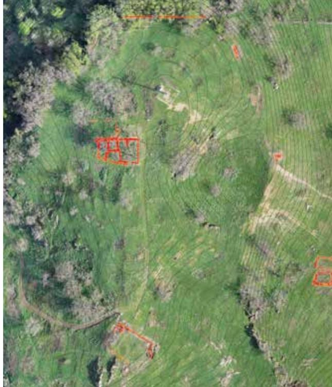
2. Ortofoto dell'acropoli con sovrapposte le curve di livello e, in rosso, il rilievo tramite fotogrammetria monoscopica delle strutture documentate nel corso degli scavi 2012-2014 (illustrazione M. Zanfini, Archivio *Tusculum*)
